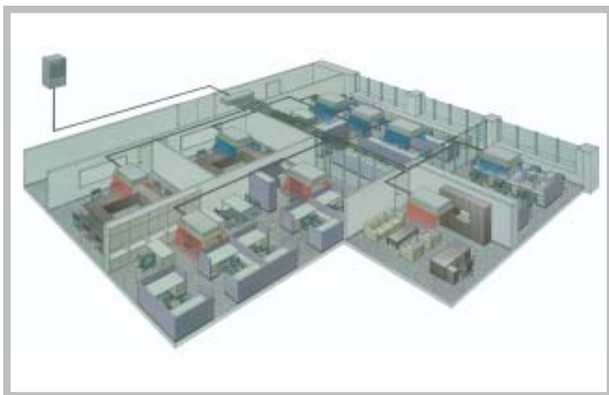
Реализация мультизональной системы с утилизацией тепла на примере Сити Мульти R2 производства Мицубиси Электрик
