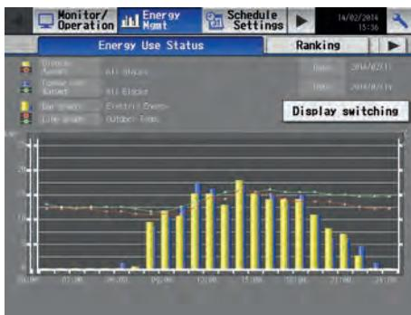
Электроэнергия, потребленная системой кондиционирования воздуха, а также время работы вентилятора внутреннего блока отображаются в виде столбчатой диаграммы с детализацией по месяцам, дням или часам.
