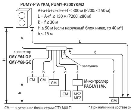
\* При наличии в составе системы внутренних блоков PKFY-P10~32VLM / PFFY-P VKM / PFFY-P VL\* / PFFY-P VCM перепад высот ограничивается значением 30 м, если наружный блок расположен ниже внутренних.
