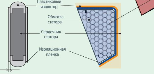
Новый изолятор занимает меньше места, поэтому для обмотки статора можно применить провод большего сечения.
