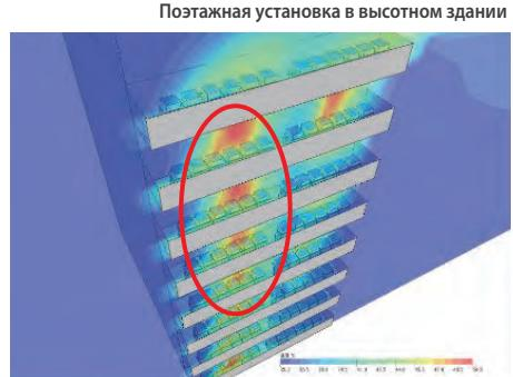
Зона высокой температуры образуется за счет конвекции воздуха, нагретого наружными блоками, установленными на нижних этажах.
