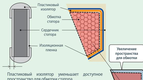
Пластиковый изолятор уменьшает доступное пространство для обмотки статора.
