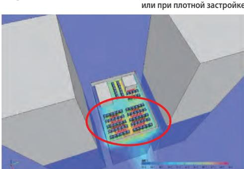
При групповой установке наружных блоков на кровле препятствия, такие как шумоотражающие экраны, ограждающие конструкции или близлежащие здания, могут создавать застойные зоны горячего воздуха.
