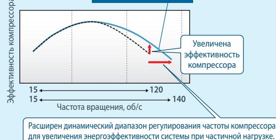
Расширен динамический диапазон регулирования частоты компрессора для увеличения энергоэффективности системы при частичной нагрузке.
