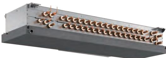
HBC-контроллер направляет хладагент, поступающий от наружного блока, в пластинчатые теплообменники «фреон-вода» и регулирует процессы теплообмена в них.
