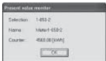
Подсчет импульсов (например, от счетчика электроэнергии)
