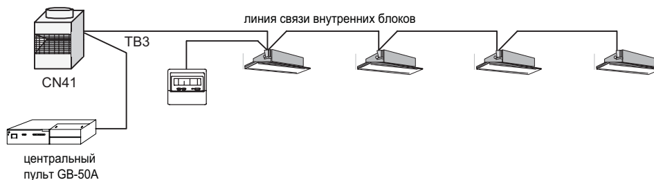
Рис. 3. Питание прибора GB-50A от межблочной линии связи.
