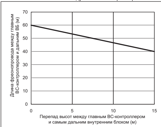
Рис. 4-3-2-1. Расстояние между ВБ и ВС-контроллером
