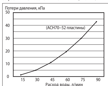
Встроенный теплообменник PUHZ-HW112, 140VNA / YNA2
