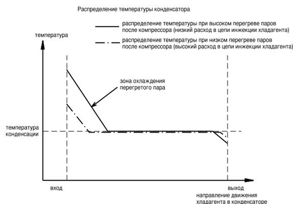
Рис. 6. Распределение температуры конденсатора
